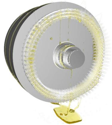
Abbildung 1: Kühlmittelverteilung (Öl) über den Wickelköpfen eines E-Motors
