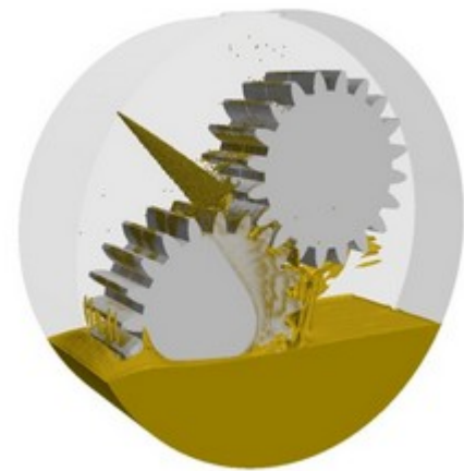
Abb. 3: Ölfilmbildung bei Einspritzschmierung
